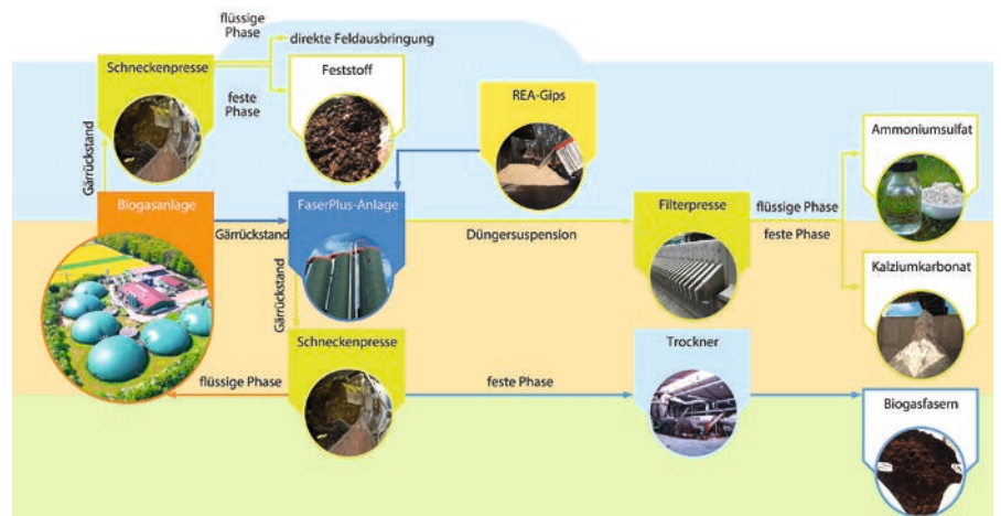
Biogasanlage BENAS und Schema deren Nährstoffrückgewinnung und -wiederverwendung. Foto/Grafik: gns
