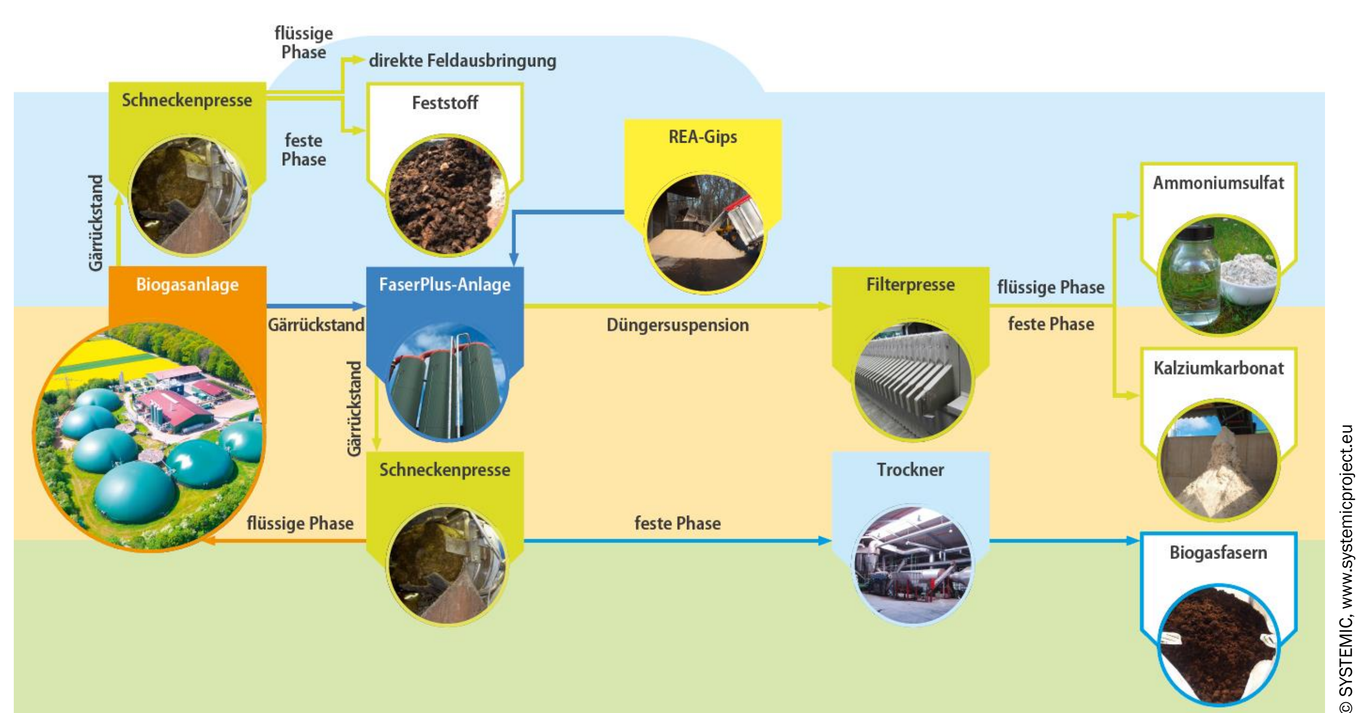
Abb. 1: BENAS-Biogasanlage mit Nährstoffrückgewinnung
